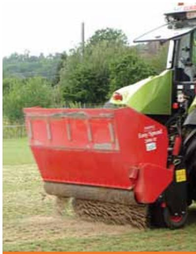
Fig. 21: sableuse en nappe autochargeuse
