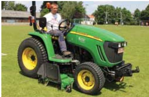
Fig. 6 : tondeuse à lames rotatives
