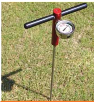
Fig. 1: mesure pénétrométrique
