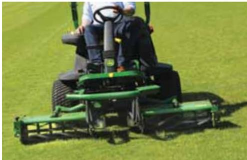
Fig. 5 : tondeuse à lames hélicoïdales
