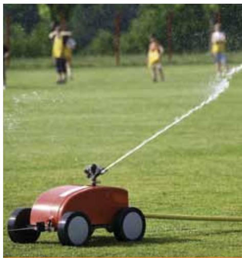
Fig. 32 : système d'arrosage par aspersion, monté sur chariot mobile
