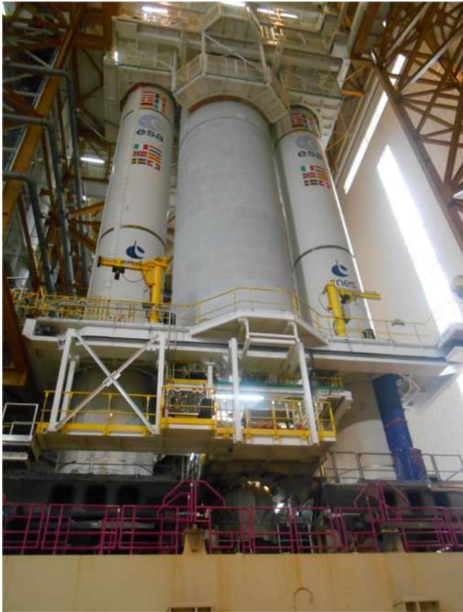
les divers éléments de la fusée sont assemblés les uns avec les autres sur la table de lancement.
