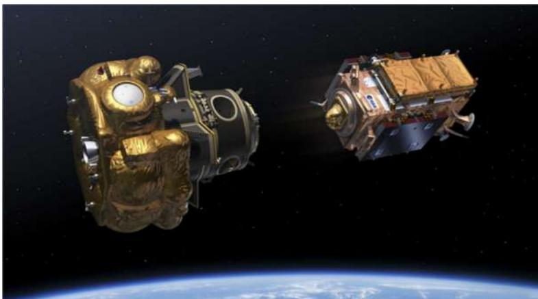
*Sentinel (à droite) déposé par l'étage Fregat( à gauche)*
